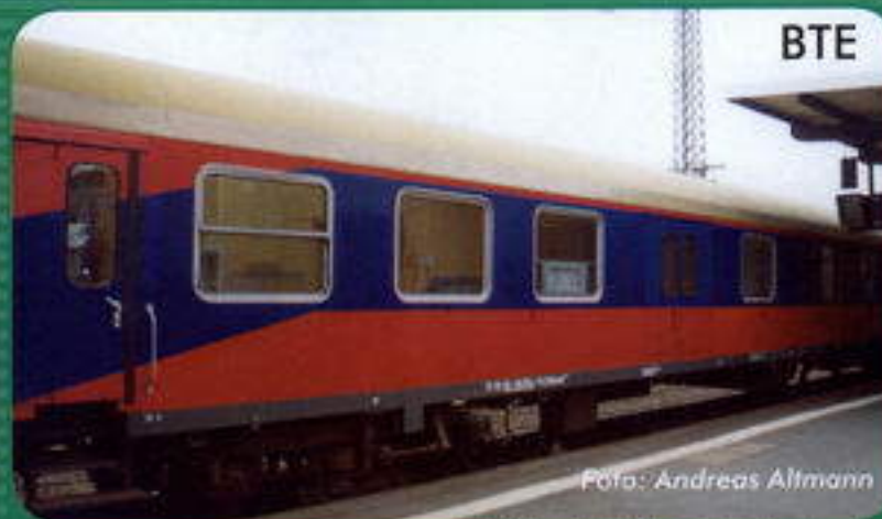
74712 Seitengangwagen 2. Klasse Bauart Halberstadt mit Gepäckabteil „Bahn Touristik Express GmbH“ 2nd class coach with baggage compartment type Hal- berstadt of the „Bahn Touristik Express GmbH“
